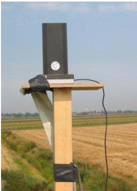
Test van een binnenantenne bij Schiphol gericht op de zender Haarlem
