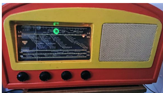
Het front van de radio zoals dat er nu uitziet met een nieuw "kattenoog" luidsprekerdoek en een goed verlichte heldere afstemschaal.
