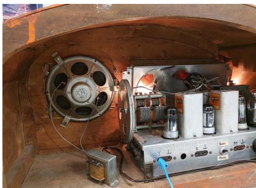
Achterin vallen de aangebrachte luidspreker en luidsprekertrafo op
