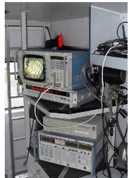
Een opstelling voor het testen van analoge TV ontvangst
