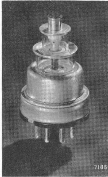
Fig. 9. Schijftriode, type EC 56. Rooster en anode worden hier gedragen door metalen schijven, die dwars door de glazen buiswand heen zijn gesmolten en die buiten de buis deel uitmaken van een afstemkring.
