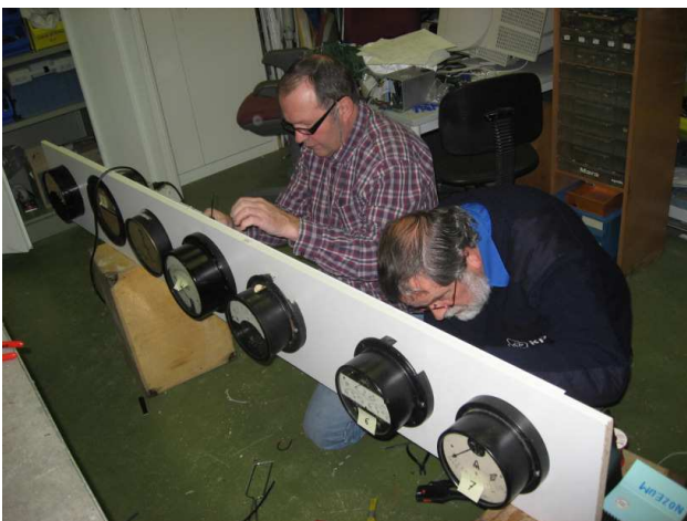
Ed Scheuierman en Ries van Rooijen brengen de bedrading aan achterop het meterpaneel.
