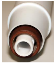
De ongeveer 30cm lange weerstand uit een watergekoelde kunstantenne.
