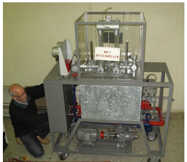
Jan Vroedsteijn legt de laatste hand aan de restauratie van de sodabad kunstantenne. Bovenop de hoogfrequent aansluiting, het sodabad is in de gegalvaniseerde bak in het midden.
